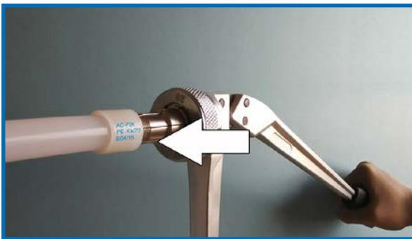
3. Abrir completamente las palancas de la herramienta e introducir los segmentos del cabezal expensor en el tubo todo lo posible.
