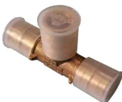
Para garantizar el perfecto estado de los accesorios de latón y válvulas del sistema AC-FIX ANILLO PLÁSTICO DE EXPANSIÓN, todas sus tetinas se suministran cubiertas por un capuchón protector, evitando así posibles desperfectos durante su manipulación. En el mismo capuchón, aparece marcado el diámetro de la pieza para una rápida identificación. \* Marca(s) de una compañía no relacionada con AC-FIX (Global Piping Systems, S.L.)
