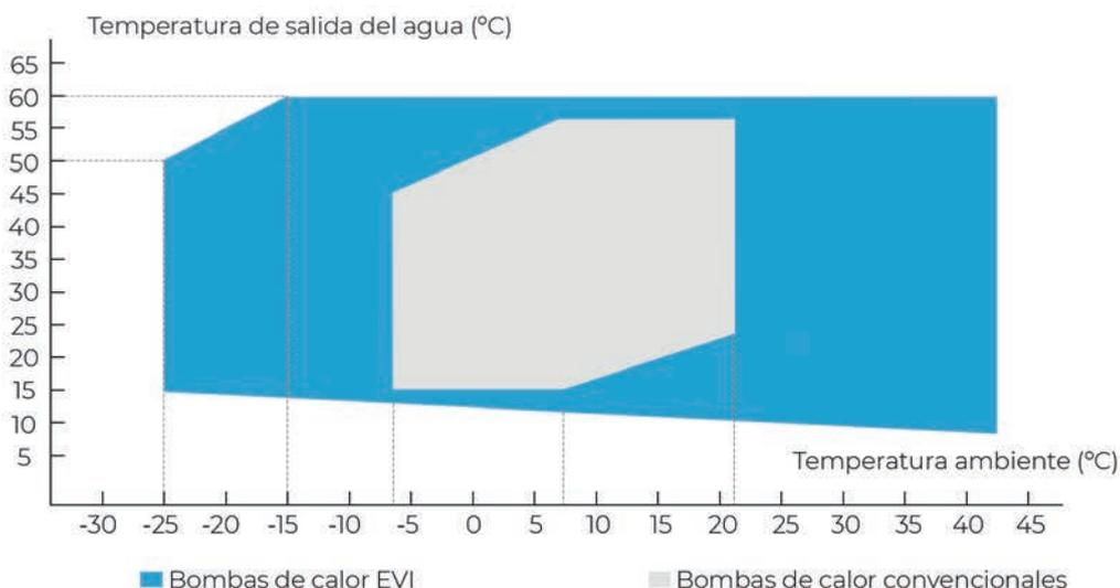
Gracias a la tecnología Inverter EVI, la bomba de calor aire-agua de la serie AeroPlus cuenta con un amplio rango de temperatura de funcionamiento para calefacción, refrigeración y agua caliente sanitaria. Significa que puede alcanzar la temperatura deseada del agua incluso en climas extremos y puede funcionar de manera segura y confiable a una temperatura ambiente tan baja como -25°C.
