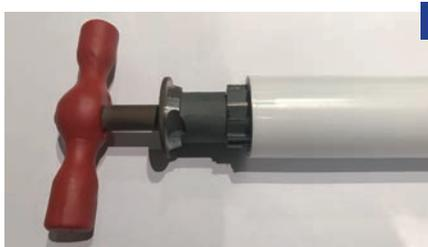
El tubo debe estar bien cortado y perpendicular a su eje. Luego, use el calibre para calibrar y biselar el tubo.
