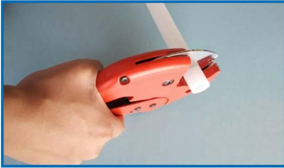
1. Es muy importante cortar el tubo de manera limpia y perpendicular a su eje.
