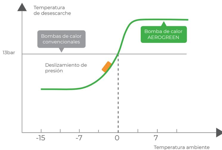
AeroGreen utiliza el desescarche inteligente para determinar, tanto el tiempo exacto de descongelación como la presión de inicio, en función de la temperatura ambiente real y así, ahorrar energía y hacer que la bomba de calor funcione con máxima eficacia incluso con las temperaturas gélidas más adversas.
