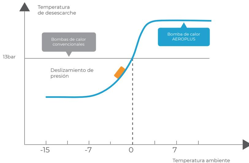
AeroPlus utiliza el desescarche inteligente para determinar tanto el tiempo exacto de descongelación como la presión de inicio, en función de la temperatura ambiente real y así, ahorrar energía y hacer que la bomba de calor funcione con máxima eficacia incluso con las temperaturas gélidas más adversas.
