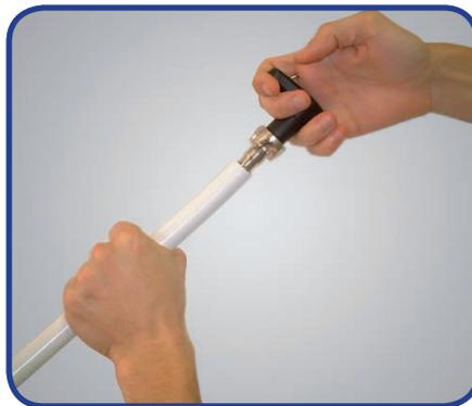
**2.** Calibrar y biselar el extremo del tubo dónde se vaya a introducir el accesorio. Este paso es importante para no dañar las juntas tóricas. El calibre AC-FIX calibra el interior y exterior del tubo.
