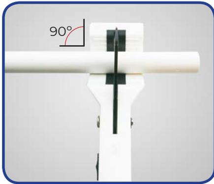
**1.** Cortar el tubo de manera limpia y perpendicular a su eje.
