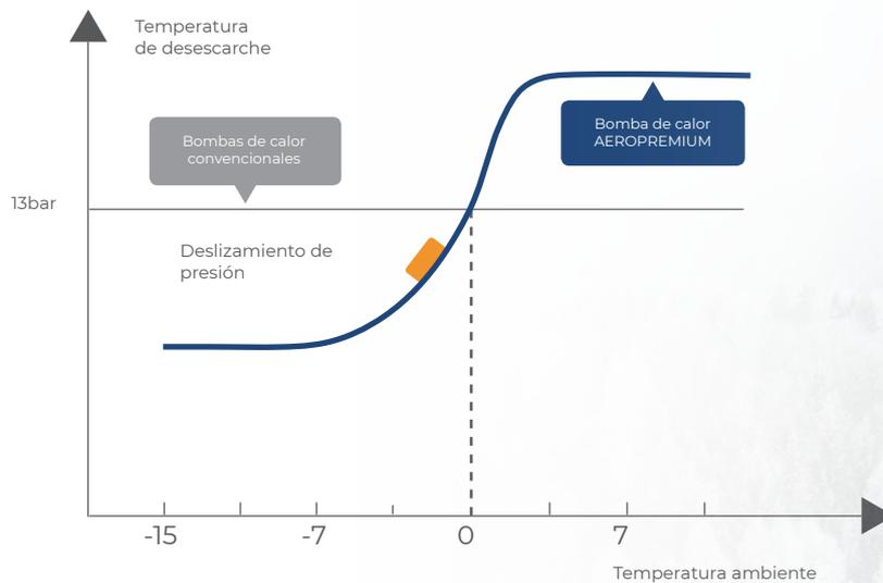
AeroPremium utiliza el desescarche inteligente para determinar, tanto el tiempo exacto de descongelación como la presión de inicio, en función de la temperatura ambiente real y así, ahorrar energía y hacer que la bomba de calor funcione con máxima eficacia incluso con las temperaturas gélidas más adversas.
