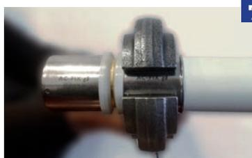
Prensar con tenazas o anillos tipo U. Posicionar el lateral de la mordaza junto al anillo de plástico y realizar el prensado. El anillo de plástico no debe prensarse.
