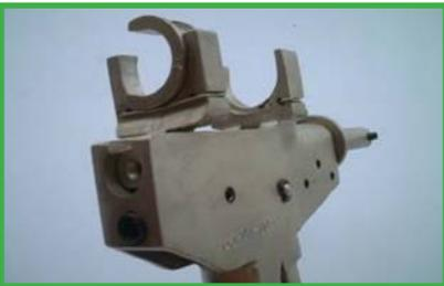
**5.** Preparar la prensa para el montaje, introduciendo las cunas correspondientes al diámetro del tubo mediante un cuarto de vuelta.
