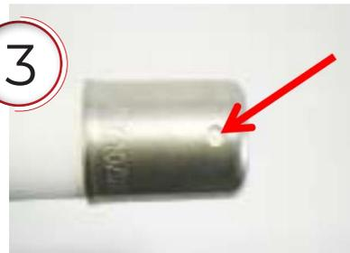
Coloque el casquillo de acero inoxidable en el extremo de la tubería hasta el fondo, de modo que la tubería se pueda ver totalmente a través de los orificios indicadores.
