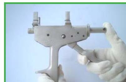
**8.** Una vez lista la unión, abrir la prensa tirando hacia arriba de la palanca y empujando el eje o cremallera.
