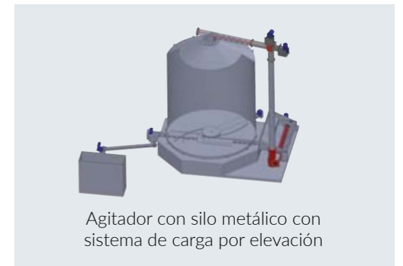
Agitador con sistema de elevación
