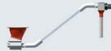
Transportes flexibles mediante sinfín
