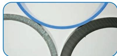
Comparativa de espesores: PVC-O, PVC-U y PE
