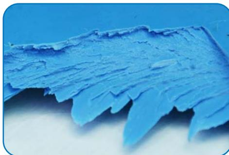
Estructura laminar de las Tuberías de PVC-O TOM®
