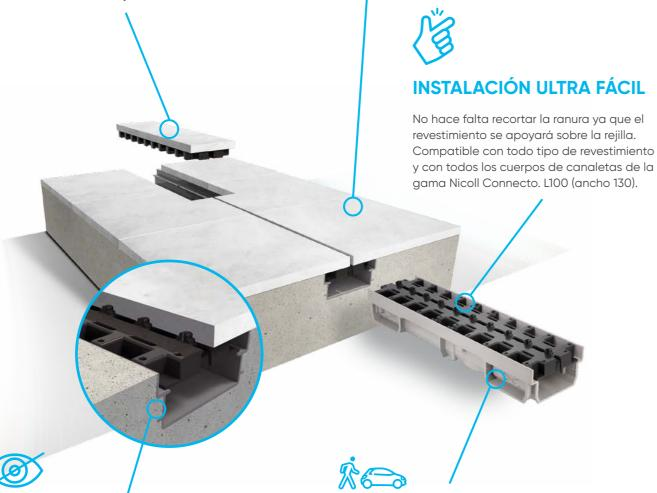
El revestimiento (losas, baldosas) se apoya y encaja perfectamente en la rejilla especialmente diseñada, haciéndola completamente invisible. Ninguna ranura o borde plástico o metálico perturbarán la belleza del entorno. El revestimiento hace tope sobre la rejilla, materializando así la ranura.
