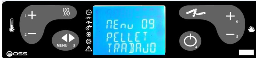
Se puede modificar la caída de pellets, pero **solo en la fase de trabajo**, no en la fase de encendido.
