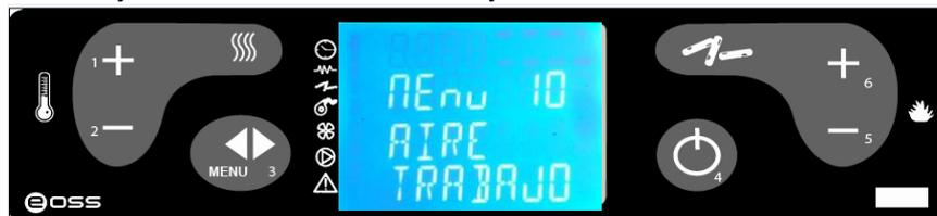
Con esta función se puede modificar el aire en la combustión, **solo en la fase de trabajo**, no en la fase de encendido.
