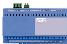
Controla los actuadores Roth NC 230V (1135007412) de un colector de suelo radiante. Conectado a la central Rothaclima 7 zonas aire frío calor, permite la gestión total de un sistema de climatización por suelo radiante y aire de hasta 7 zonas. Incorpora salida para bomba de suelo radiante y doble salida adicional de suelo radiante on calor / on frío para control de la producción. Posibilidad de configurar un termostato para control de hasta 3 zonas al mismo tiempo.
