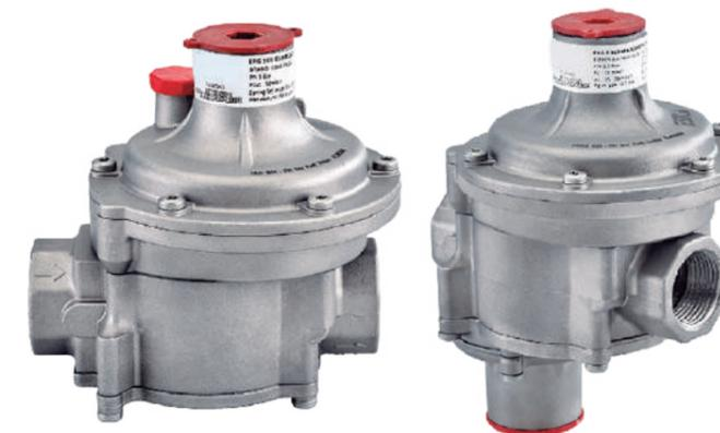
Los reguladores de presión de gas de la serie ERG se utilizan en las instalaciones de gas para reducir la presión de entrada máxima de 0,5 bar a la presión de salida deseada entre 16 y 150 mbar. El rango de la presión de salida se puede ajustar con la elección de un muelle diferente.
