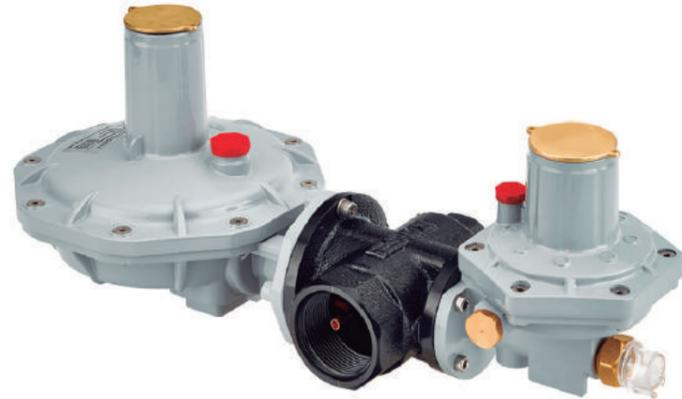
Los reguladores de presión de la serie ERG-H5 son adecuados para uso comercial y ERM, con presiones de entrada máximas de 20 bares y de salida hasta 2,5 bares. Se utiliza principalmente para gas natural y también es adecuado para gases no corrosivos. El ERG-H5 es un regulador de una etapa de acción directa con sistemas de seguridad opcionales como las VAS, VIS máx. y VIS mín.
