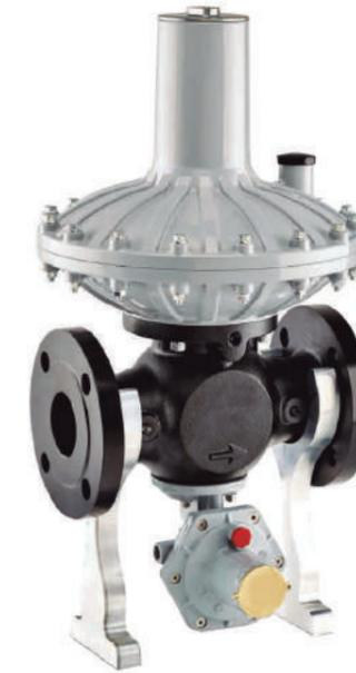
El regulador de presión de la serie ERG-H6 se utiliza en la línea de gas para reducir la presión de entrada a la presión de salida deseada. Se utiliza principalmente en la distribución de gas natural y también se puede utilizar con gases no corrosivos. El ERG-H6 es un regulador de acción directa de una sola etapa con sistemas de seguridad opcionales como la válvula de VAS, VIS máx. y VIS mín. También está disponible la versión con monitor.
