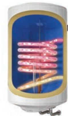
El **TURBULATOR** es un elemento metálico con aberturas especiales, integrado a lo largo de toda la longitud del tubo del intercambiador de calor. Rompe el núcleo caliente del fluido que circula por el intercambiador de calor, aumentando así la eficiencia de la transferencia térmica al agua dentro del tanque.
