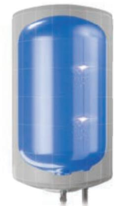
El método de **SOLDADURA POR PLASMA** asegura una unión duradera y de alta calidad entre los bordes de la hoja de acero que forma el cilindro del tanque de agua, mediante el empleo de un control computarizado y una temperatura de soldadura más baja. La ausencia de materiales extra en el proceso de soldadura otorga una superficie más lisa, lo que asegura un esmaltado de alta calidad.
