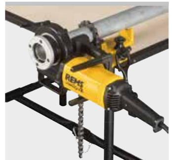
Robustos bancos de trabajo plegables y fácilmente transportables para uso universal. Tableros de trabajo según DIN 68 705. Para instalación e industria. Para obra y taller.
