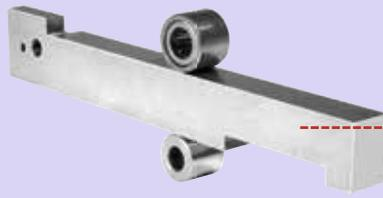
Biela rectangular estable en acero especial macizo, apoyada sobre rodamientos de aguja en dirección de carga, conducida en todas las direcciones y a través de todo el recorrido de serrado, para un corte recto sin torsión incluso en aplicaciones duras con una presión de serrado muy elevada, p. ej. al utilizar una guía multiplicadora de potencia. Para una duración extremadamente larga.
