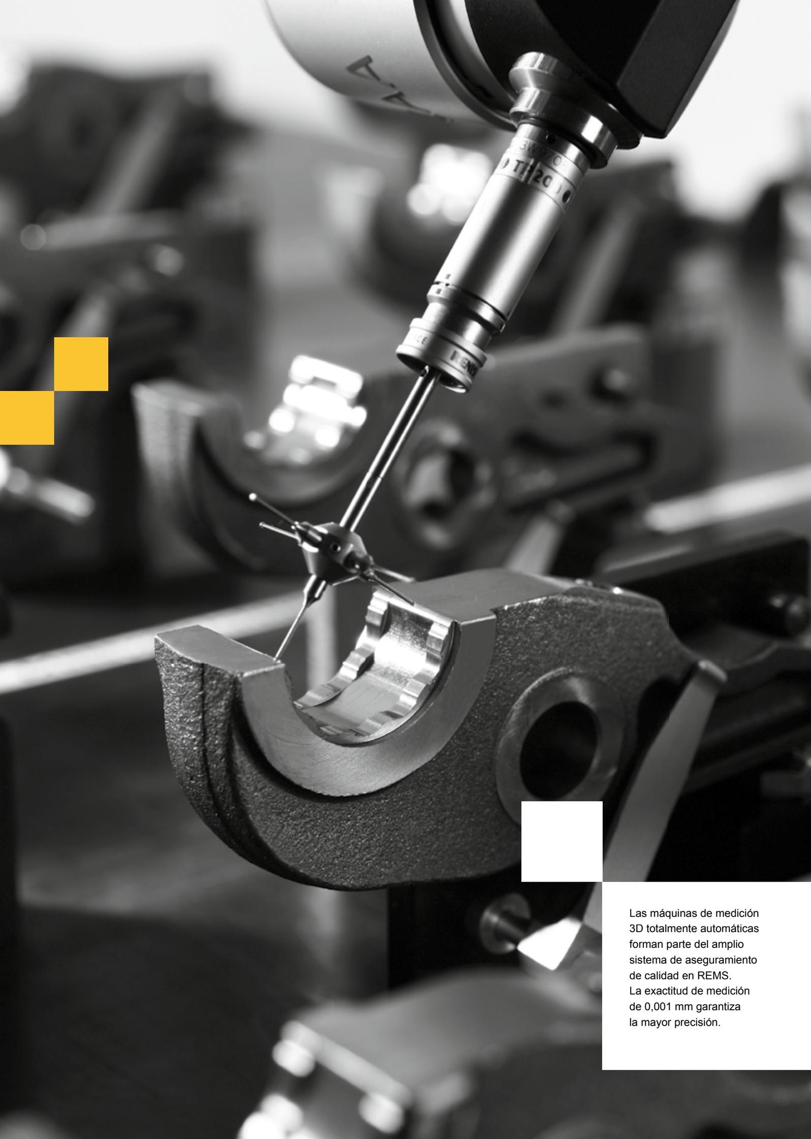
Las máquinas de medición 3D totalmente automáticas forman parte del amplio sistema de aseguramiento de calidad en REMS. La exactitud de medición de 0,001 mm garantiza la mayor precisión.
