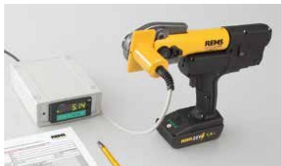
El servicio en REMS se escribe a lo grande: todos los vehículos de demostración de los más de 200 asesores especializados de REMS están equipados con un dispositivo de pruebas, con el que se puede realizar en cualquier parte la prueba de funcionamiento y la medición de fuerza de prensado de las prensadoras radiales REMS.
