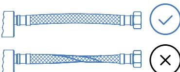
**No instalar la conexión con la parte flexible en torsión.**
