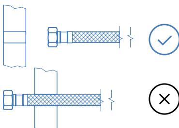
**No instalar las conexiones empotradas en una pared.**
