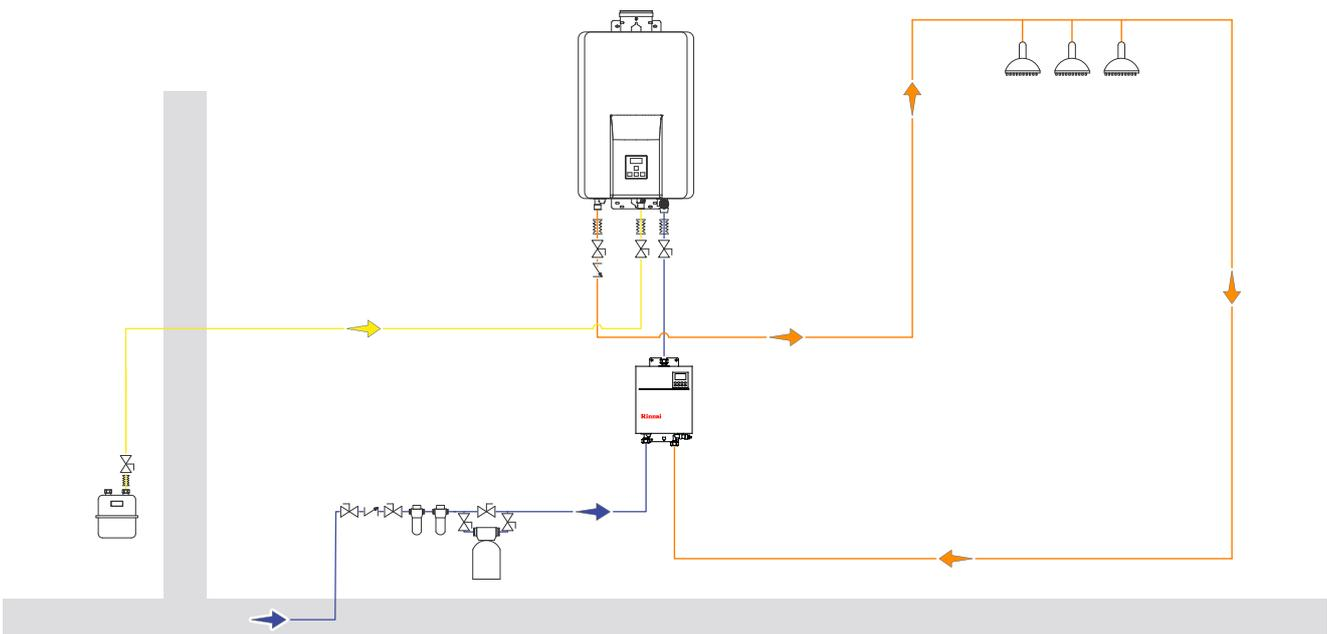
\* Calentador doméstico con potencia inferior a 35 kW. En este ejemplo está colocado el Kit para recirculación cod. RRCD-XGT.
