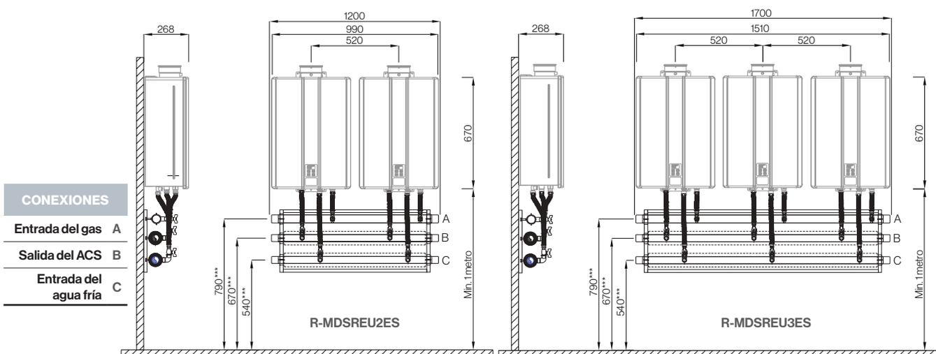
Modus Infinity Essential no prevé la conexión con acumulación ni con recirculación.
