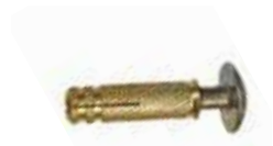
Anclaje escamoteable de dos piezas : taco latón y tornillo inox Long. 35mm- Diám. 10 mm- Rosca M-8
