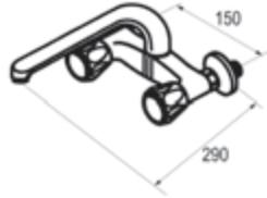
Distancia entre entradas de 130-170 mm y caño fundido de 26 cm
