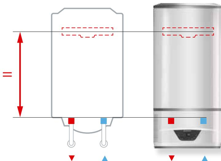
La distancia entre las fijaciones y las conexiones hidráulicas son las mismas entre un termo eléctrico estándar y un Lydos Hybrid de la misma capacidad.
