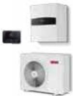
Bomba de calor aire/agua reversible monobloc de alto rendimiento y dimensiones compactas con gas ecológico R32. Unidad interior de instalación en pared con filtro magnético y de partículas, vaso de expansión de 12 litros y resistencias eléctricas de apoyo. Incluye SENSYS NET HD y sonda externa. Tecnología monobloc: sin manipulación de gas refrigerante, sólo conexiones hidráulicas. Conectividad ARISTON NET incluida de serie.
