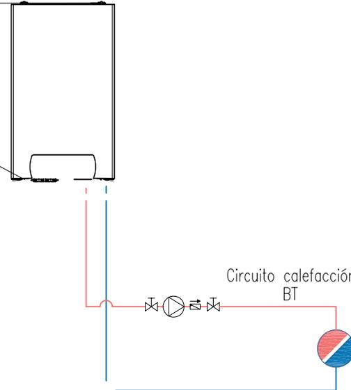
Sistema doméstico de producción de ACS y aporte a calefacción de Baja Temperatura (Suelo Radiante) mediante acumulación de inercia VSCH con bomba y centralita de control integradas
