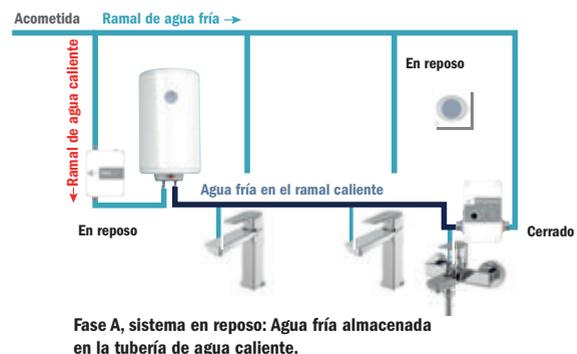
Fase A, sistema en reposo: Agua fría almacenada en la tubería de agua caliente.
