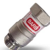
**Aplicación:** Su uso evita condensaciones en suelos refrescantes en los cuartos húmedos en los que no se ha colocado termostato (cuartos de baño, aseos y/o cocina). La válvula se instala a la salida del colector en los circuitos correspondientes a estos cuartos húmedos y corta la circulación de agua en los circuitos en los que se instala cuando la temperatura baja de 19°C
