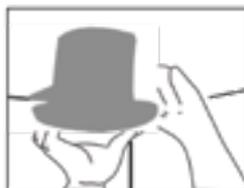
REALICE EL CORTE DELINEADO UTILIZANDO EL ASA DE AJUSTE DE LA CAJA DE EXTRACCIÓN COMO PLANTILLA.
