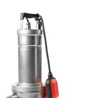
Bomba centrífuga sumergible de acero inoxidable con rodete vortex de acero micro fundido, adecuada para la elevación de aguas negras y aguas residuales en general con sólidos de hasta 50 mm. Asa revestida de goma aislante.
