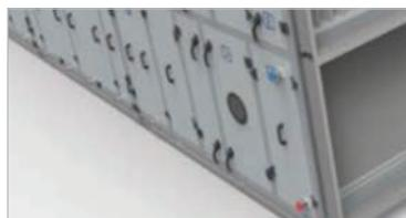
Paneles con rotura de puente térmico fabricados en chapa galvanizada de 0,7m de espesor protegidos **con revestimiento de poliéster, con poliéster pintado o en acero inoxidable acabado anti reflectante.**
