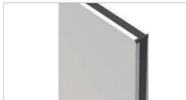
Paneles con aislante térmico hechos de chapa galvanizada con revestimiento de alta resistencia. Protección contra incendios clase A1. Paneles de acceso fijados por abrazaderas, con tiradores. Sellado de paneles de acceso-construcción por junta de perfil.
