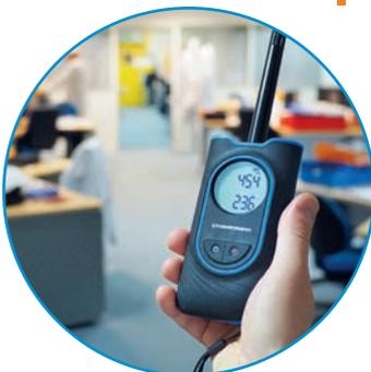
TEMPERATURA Y HUMEDAD RELATIVA DEL AIRE AMBIENTE (CÁLCULO DEL PUNTO DE ROCÍO Y LA TEMPERATURA HÚMEDA)
