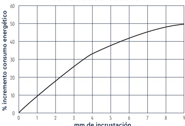
Una incrustación del grosor de la cáscara de un huevo incrementa el consumo energético en más de un 7%.
