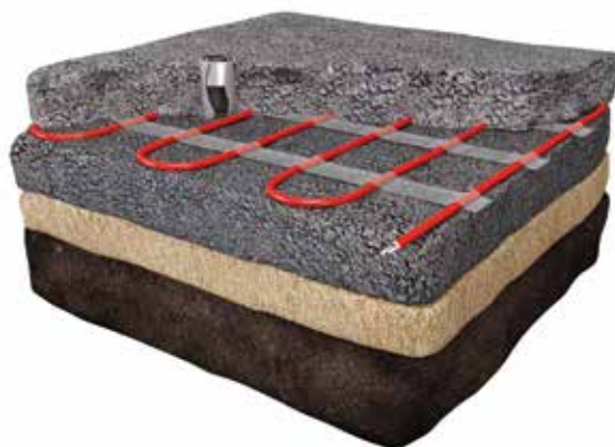
Instalación en asfalto
