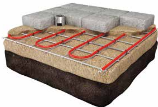
Instalación bajo adoquines
