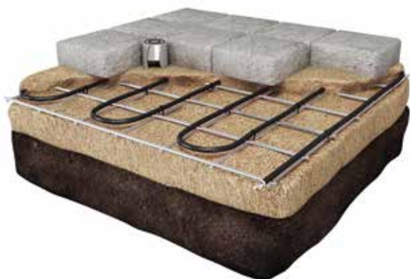
Instalación bajo adoquines
