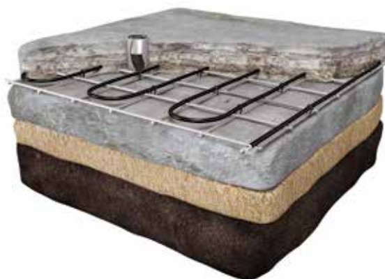
Instalación en Hormigón
