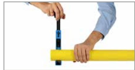
3. Cortar el tubo de forma totalmente recta.
