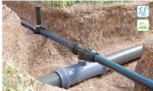
La imagen muestra una te junta elástica SLIDE con salida reducida r/h, en una instalación de derivaciones para el montaje de aspersores. Tanto la te slide como el collarín toma llevan elementos metálicos en acero inoxidable, adaptándose perfectamente a su uso enterrado.
