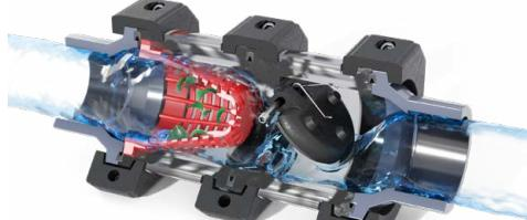
El conjunto **SCREEN PLUS** aprovecha las sinergias del filtro **SCREEN PLASTIC** y la válvula de retención lineal **SNS** con cuerpo visor transparente ofreciendo una solución única en el mercado, al **incorporar un filtro protector a la válvula antirretorno**, además de permitir un control visual de sus elementos. Unido mediante **bridas SNS** podremos montar y desmontar fácilmente sus componentes para su mantenimiento.
