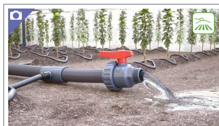
Válvula "Semi-compact" en final de línea para vaciado de seguridad frente a heladas. / "Semi-compact" valve at the end of the line for frost safety drainage. / Vanne "semi-compact" en fin de ligne pour la vidange hors gel.
