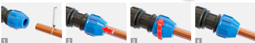
1. Marcar la profundidad de inserción en la tubería y aflojar la tuerca con cuidado para evitar el desmontaje completo.
