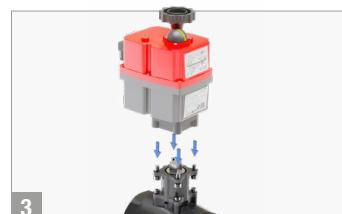
Retirar la maneta y corona dentada, liberando los tornillos que fijan ambas partes al cuerpo de la válvula.
