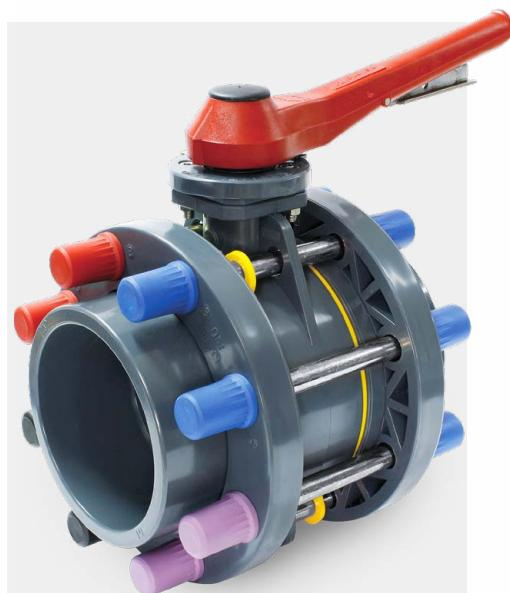
El uso del **TAPÓN PROTECTOR** garantiza la perfecta conservación de las partes metálicas protegidas, aumentando la vida útil de la instalación y facilitando las operaciones de montaje y desmontaje al evitar la oxidación de la parte expuesta de los tornillos, la mayor razón por la que se producen gripajes.
