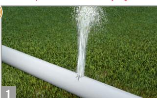
1. Al producirse una rotura en la tubería, hay que parar la instalación y vaciar la tubería para proceder a la reparación. / When a pipe is broken, the installation must be stopped, empty the pipe and proceed to the repairation.
