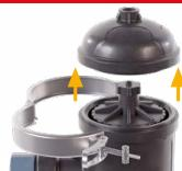
Asegúrándonos que el filtro no tiene presión, soltaremos la brida y quitaremos la tapa. / Being sure that the filter has no pressure, we will open the clamp and remove the cap.
