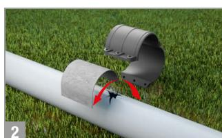
2. Para hacer la reparación, se centran la junta de cierre (H3C) sobre la rotura y se coloca el collarín, de forma que cubra la junta completamente. / To make the repairation, the closing gasket (H3C) is centered over the breakage and the hinged sleeve is installed covering the gasket completely.
