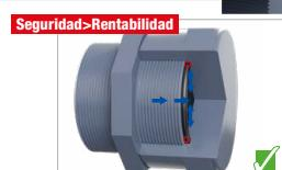
Aplicación de tapón r/h con junta. / f/t plug
