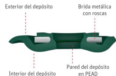
El sistema brida asegura la calidad del agua potable en todo momento ya que en ningún momento entra en contacto el agua con la parte metálica interna. Internamente la brida dispone de pared en PEHD y su estructura metálica sirve solamente para asegurar un mayor par de apriete de sus roscas, asegurando la estanqueidad de la conexión del accesorio de vaciado al depósito.
