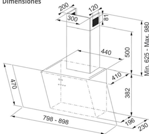
Se recomienda una instalación mínima a 47 cm sobre la zona de cocción. Doble sistema de aspiración: perimetral y adicional en la zona inferior.
