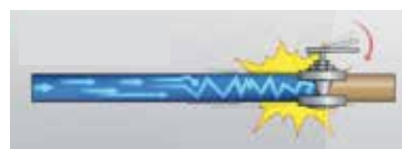
Cierre repentino (ocasiona el golpe de ariete)
