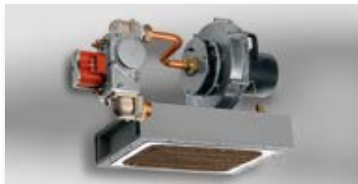
Grupo de combustión premix de CO 2 constante (válvula gas modulante, ventilador modulante y quemador en acero INOXIDABLE)
