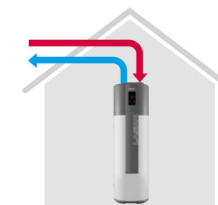
Entrada y salida de aire directa del exterior
