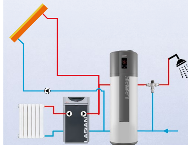
Esquema de funcionamiento de AQUARIA 250 S3 con una fuente de energía externa de apoyo de una caldera o energía solar.
