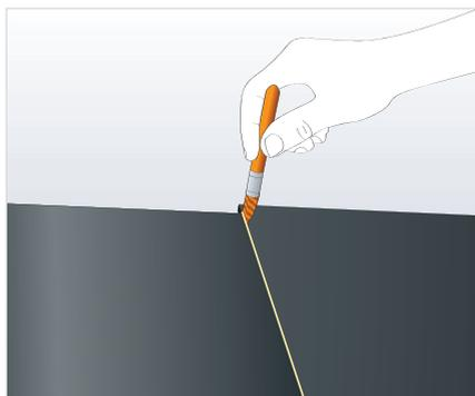
Una vez que se presione junto, el material debe someterse a presión y no debe estirarse.
