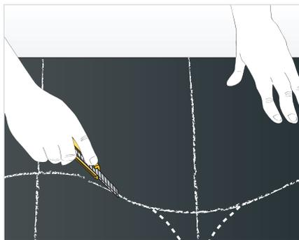
Mida la semicircunferencia empleando un compás de puntas y marque 3 arcos. Una los arcos con una línea continua. Corte a lo largo de la línea. Una vez que se hayan desplazado 180°, las secciones superior e inferior generan las dos partes de la unión sesgada.
