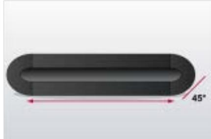
1. Coja una coquilla Armaflex sin cortar del mismo diámetro que la ramificación del conducto principal pegado. Con un cuchillo afilado, corte la coquilla en dos mitades iguales.
