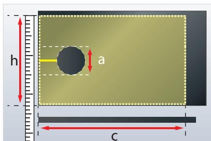
**Nota:** En el caso de vástagos de válvulas sin bridas de conexión, se recomienda marcar los cortes en el primer cuarto de la plancha Armaflex.
