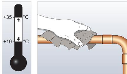
Limpie todo el polvo, suciedad, aceite y agua de las tuberías con el disolvente Armaflex donde sea necesario. Instale Armaflex con una temperatura ambiente entre +10 y +35°C.
