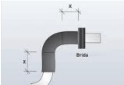
6. Coloque la cubierta de aislamiento sobre el codo de la tubería. Permita que el adhesivo se seque ligeramente y después presione las caras de la unión de forma firme hasta que se junten.
