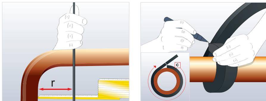
Determine el radio interior ( $r$ ), trazando una línea perpendicular que corte una línea horizontal trazada desde la parte exterior de las dos soldaduras. El punto de intersección de estas dos rectas indica el origen del radio ( $r$ ). Éste representa el radio interior.
