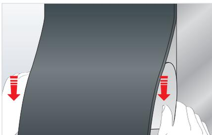
Alinee el material. Para obtener un buen alineamiento presione con firmeza mientras retira con cuidado el papel de protección. En los extremos, deje un sobrante de 5 mm para la compresión.
