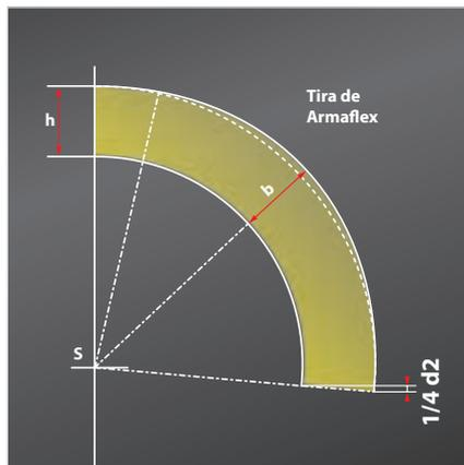
Pase la medida tomada a la superficie de la plancha Armaflex, tal y como se muestra en la imagen.
