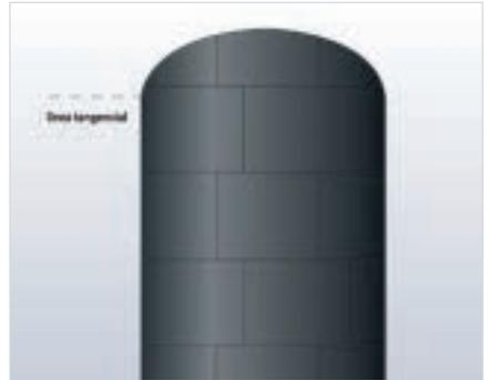
Para terminar, haga un sellado\* de los paneles abombados con respecto a las secciones del cuerpo con el aislamiento principal, como se muestra en el capítulo relacionado con los recipientes de menos de 1,5 m.
