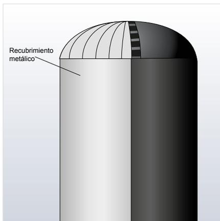
Las superficies restantes de la parte superior del depósito entre las tiras de soporte pegadas deben estar completamente aisladas con planchas de Armaflex.
