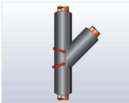
2. Corte el extremo de las secciones de la coquilla a 45° para crear la tubería de la ramificación. De forma paralela al corte, con un cuchillo afilado, rebaje de forma semicircular el extremo de la sección de la coquilla correspondiente a la ramificación. Es mejor tener un corte que sea demasiado profundo que otro que sea demasiado escaso.
