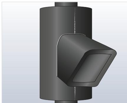
15. Corte la forma señalada y aplique adhesivo a todas las costuras. Deje que el adhesivo se seque ligeramente y enrolle el panel alrededor del disco terminal sin estirarlo durante la aplicación. Compruebe el alineamiento.
