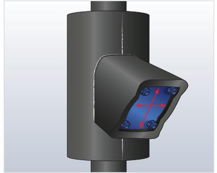
11. Trace una línea central y un contorno exterior para la parte del filtro. Corte la plancha y aplique adhesivo a la costura longitudinal. Pegue el aislamiento al cuerpo de la válvula de filtro empleando el adhesivo Armaflex.
