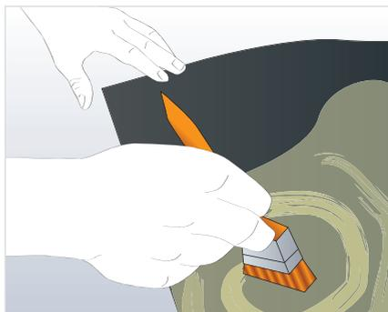
Extienda una fina capa de adhesivo sobre la superficie del metal y después sobre la plancha Armaflex.
