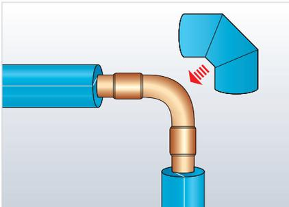
Aísle todas las demás secciones rectas de la coquilla siguiendo el procedimiento anteriormente descrito. Finalmente, aíse todos los codos, uniones en T, etc. (véase “Codo segmentado con una pieza central – 2+1 empleando una coquilla Armaflex” en la página 23).
