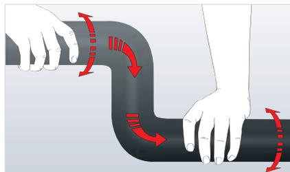
**Nota:** No intente tirar de la coquilla Armaflex para moverla a lo largo de la tubería, ya que ésta podría rasgarse.
