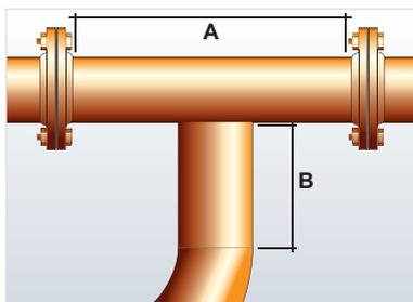
2. Determine la longitud A de la tubería principal y la longitud B de la ramificación que se deben aislar.
