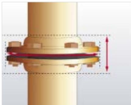
Empleando un calibre, determine el diámetro de la cara de la brida. Añada 10 mm a esta medida. Mida la longitud de la brida (incl. pernos) y añada el doble del espesor de aislamiento de la plancha empleada.
