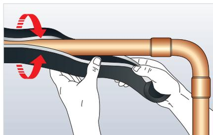
Abra la coquilla Armaflex preseccionada y colóquela sobre la tubería (el papel de cubierta protege la tira autoadhesiva).
