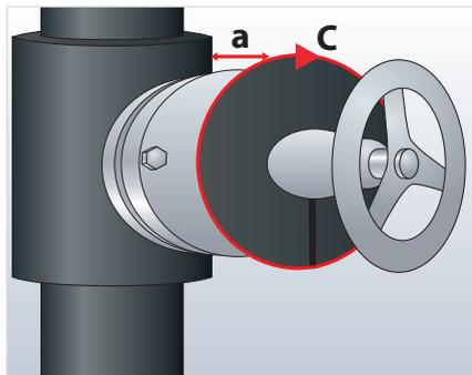
Corte el disco en uno de sus lados; aplique adhesivo en las dos caras y déjelo secar ligeramente. Una el disco terminal después de haberlo colocado sobre el cuello del vástago. Mida la circunferencia del disco terminal con una tira de Armaflex y lleve la medida a la plancha.
