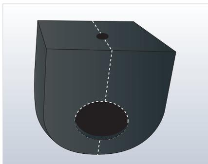
Haga perforaciones para las conexiones de las tuberías aisladas en cada uno de los paneles terminales y un agujero final para la conexión del vástago de la válvula en la parte superior. Corte la caja en dos mitades y adáptela alrededor de la válvula. Para terminar, aplique adhesivo Armaflex a las costuras de fijación, déjelo secar ligeramente y únalas. Selle de forma estanca las conexiones (uniones) de las tuberías aisladas linealmente empleando el adhesivo Armaflex.
