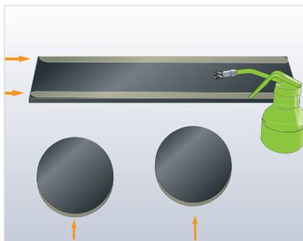
Lleve estas medidas a una pieza de la plancha Armaflex. Marque dos círculos concéntricos con un compás de puntas. Repita la operación en una segunda pieza de la plancha. Corte dos anillos de Armaflex.
