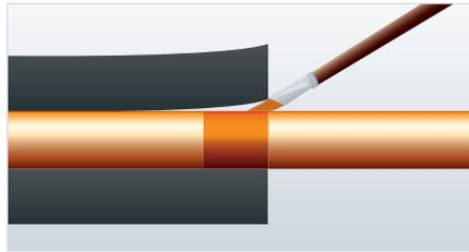
1. En todas las instalaciones frías se deben fijar y asegurar a la superficie de las tuberías los extremos de las coquillas y planchas Armaflex con el adhesivo Armaflex.
