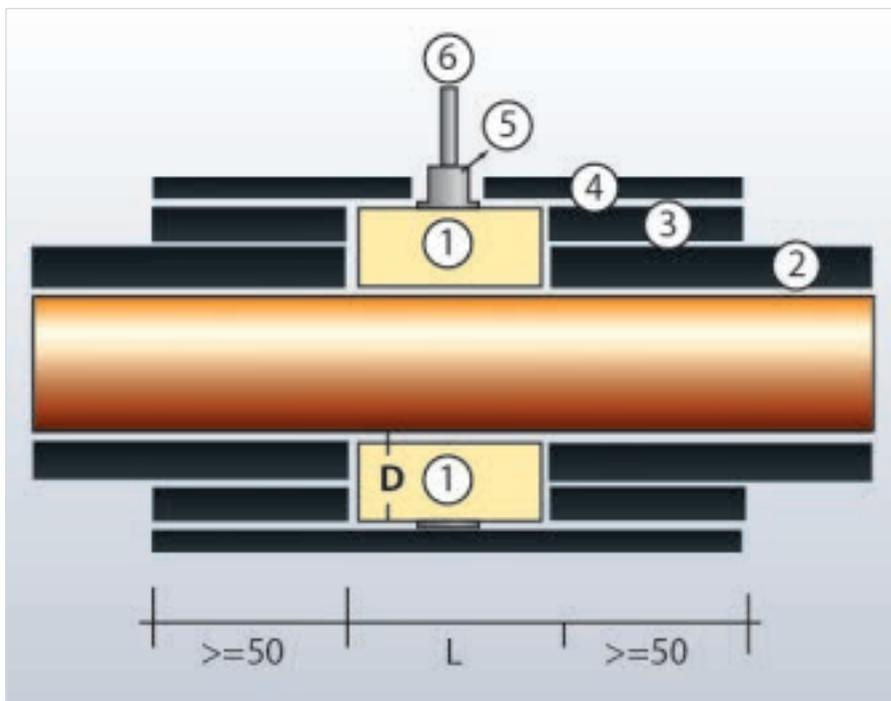
1. Soporte hecho de espuma rígida de PU
