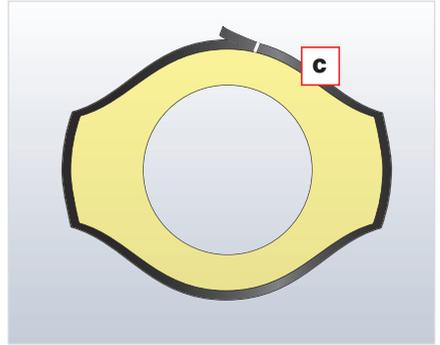
9. Pegue ambos discos justo a continuación del acoplamiento del modo indicado.
