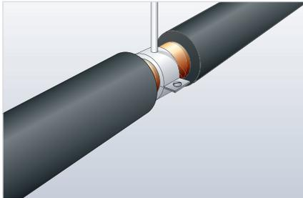
1. Instale la coquilla Armaflex tan cercano a la abrazadera de fijación como sea posible. Pegue los extremos de la coquilla con la tubería, utilizando adhesivo Armaflex.
