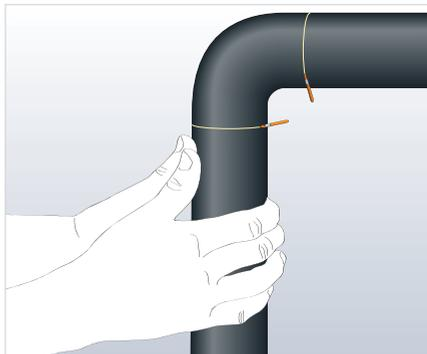
Coloque la cubierta de aislamiento sobre el codo de la tubería. Permita que el adhesivo se seque ligeramente y después presione las caras de la unión de forma firme hasta que se junten.
