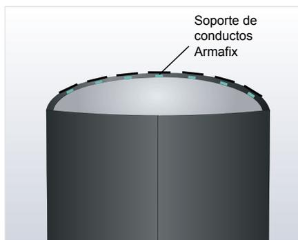
Corte las tiras de soporte planas a la longitud requerida siguiendo el arco de la parte superior del depósito. Centre y pegue en su sitio, aplicando el adhesivo Armaflex en ambas superficies de los soportes planos.
