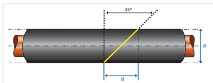
**Nota:** Las líneas amarillas indican el lugar donde se deben hacer los cortes. Use la plantilla Armaflex que encontrará en cada caja de coquillas para medir los ángulos correctamente.
