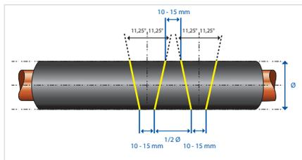
**Nota:** Las líneas amarillas indican el lugar donde se deben hacer los cortes. Use la plantilla Armaflex que encontrará en cada caja de coquillas para medir los ángulos correctamente.
