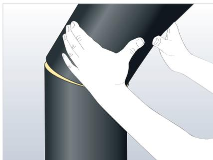
Aplique el adhesivo Armaflex al corte longitudinal, y después a la costura de unión.
