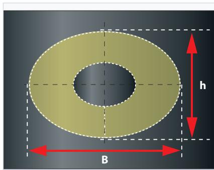
Mida la altura de la brida de la caja del vástago y su anchura y elabore un disco terminal.
