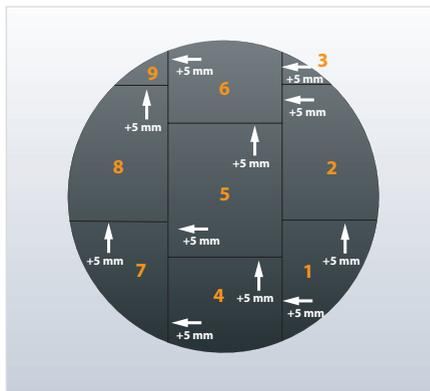
Para determinar el perfil de corte del borde circular de la sección terminada del cuerpo del extremo abombado, marque el borde circular de Armaflex con tiza blanca.
