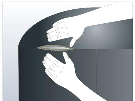
7. Una vez que el adhesivo se haya secado ligeramente (“prueba de la uña”) coloque la plancha Armaflex en su posición en la parte superior del depósito y presione con firmeza hacia abajo desde el centro, evitando cualquier desplazamiento del material, para obtener una buena unión.
