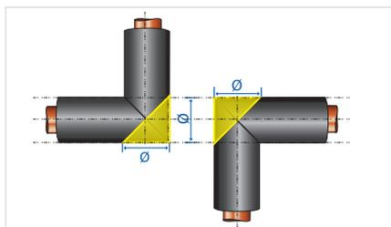
**Nota:** Las líneas amarillas indican el lugar donde se deben hacer los cortes. Use la plantilla Armaflex que encontrará en cada caja de coquillas para medir los ángulos correctamente.
