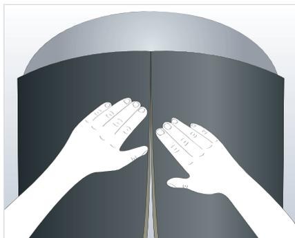
2. Lleve la circunferencia a la plancha Armaflex y corte según el tamaño adecuado. Extienda una fina capa de adhesivo sobre la plancha Armaflex, y después sobre la superficie de metal. Una vez que el adhesivo se haya secado ligeramente (“prueba de la uña”) coloque la plancha Armaflex en su posición y presione con firmeza para obtener una buena unión. De esta forma se fija la primera plancha Armaflex unos 50 mm por encima de la línea tangencial.
