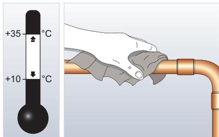
Limpie todo el polvo, suciedad, aceite y agua de las tuberías con el disolvente Armaflex donde sea necesario. Instale Armaflex con una temperatura ambiente entre +10 y +35°C.
