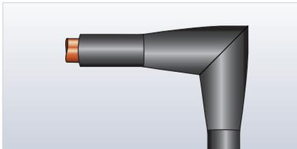
1. La cubierta de la junta se realiza con una coquilla, cuyo diámetro debe corresponder al diámetro exterior máximo de la junta atornillada. Se debe disponer de una solapa de al menos 38 mm a partir del extremo de la junta a cada uno de sus lados.
