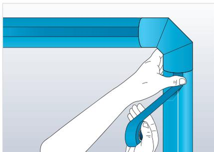
Para una mayor seguridad, es necesario asegurar las juntas longitudinales de las coquillas autoadhesivas Armaflex Ultima con una cinta autoadhesiva Armaflex Ultima adicional. Asegúrese de que la superficie esté limpia, seca y libre de contaminación. Si es necesario, límpiela con el disolvente Armaflex.
