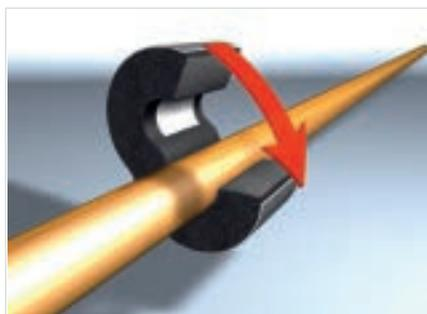
Al instalar el soporte Armaflex en la tubería, retire la tira de protección del material auto-adhesivo de ambos lados. Cierre la costura aplicando presión firme.
