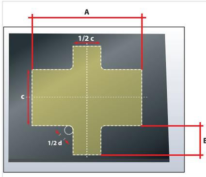
3. Marque líneas de referencia verticales y horizontales en la plancha Armaflex. Lleve las medidas determinadas como indicado en el esquema.
