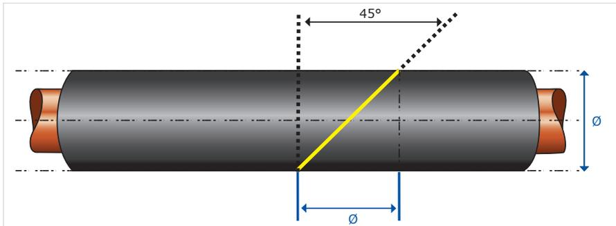
**Nota:** Las líneas en amarillo indican dónde se deben realizar los cortes. Para obtener los ángulos exactos, utilice la plantilla Armaflex que hay en las cajas de coquillas Armaflex.
