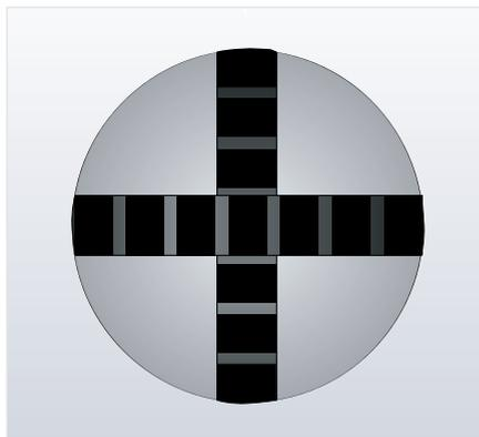
Para los depósitos pequeños ( $\varnothing < 1000\text{mm}$ ), se suele recomendar una disposición transversal (en forma de cruz). Para depósitos grandes, se pueden instalar varias tiras de soporte planas en un patrón radial simétrico. Sin embargo, la disposición puede variar para adaptarse a los requisitos individuales.
