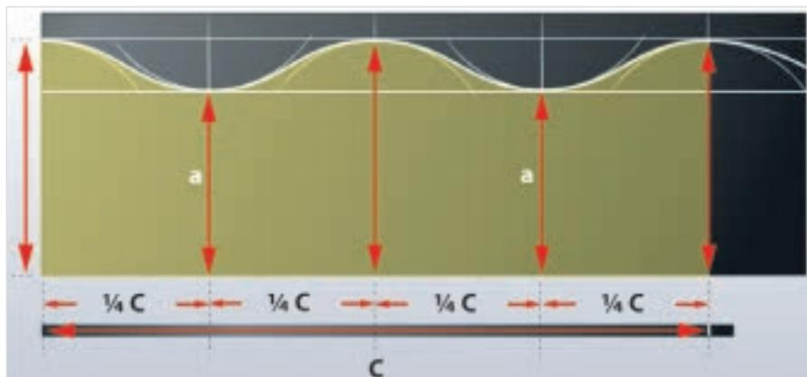
Divida la circunferencia en 4 secciones iguales. Mida las alturas máxima y mínima de la caja del vástago, incluyendo el grosor del disco terminal de Armaflex. Lleve estas alturas a la plancha Armaflex.
