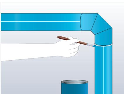
Selle todas las juntas con el adhesivo Armaflex Ultima. No ejerza tensión al sellar las uniones. Para el pegado de juntas con presión, sin espacios visible, debe aplicarse el método de adhesivo líquido.
