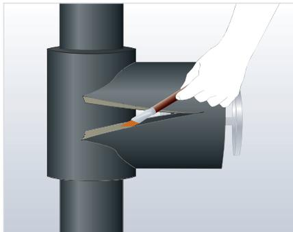
Rebaje el espesor interior en su punto más alto (donde la plancha reposa contra el lado del cuerpo de la válvula). Aplique adhesivo a la costura longitudinal, déjelo secar ligeramente y después selle alrededor de la caja del vástago.
