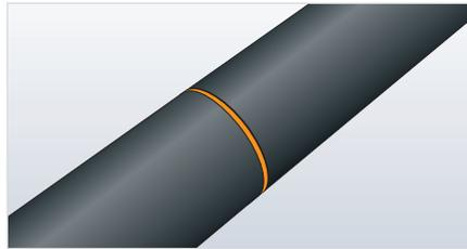
3. En el sellado húmedo final de la coquilla o plancha, se debe apartar la unión al tope comprimida con el dedo y aplicar una película fina y homogénea de adhesivo a los dos extremos de la junta con una brocha pequeña.
