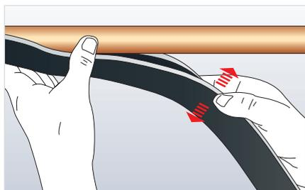
Ajuste la coquilla Armaflex colocada para garantizar que se puede acceder sin problemas al corte.
