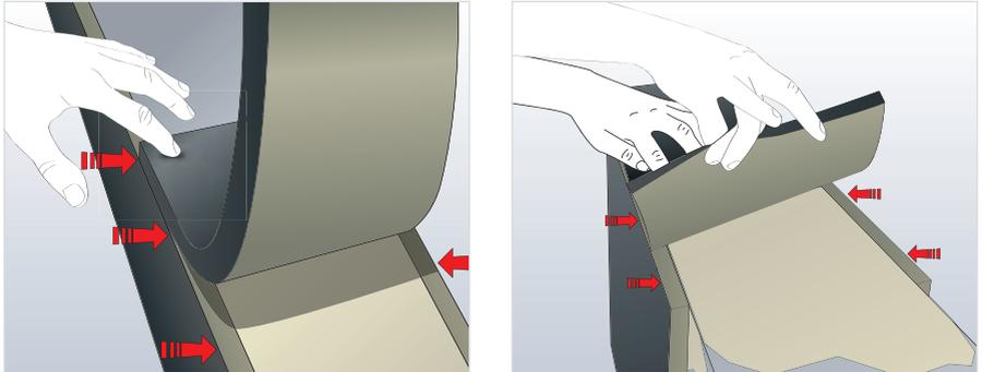
Una vez que el adhesivo se haya secado ligeramente (“prueba de la uña”), coloque la plancha Armaflex en su posición y presione con firmeza para obtener una buena unión. Continúe aplicando el adhesivo Armaflex a ambas superficies, incluyendo en el borde de la plancha Armaflex, y deje que se seque ligeramente antes de presionar con firmeza para obtener su unión.
