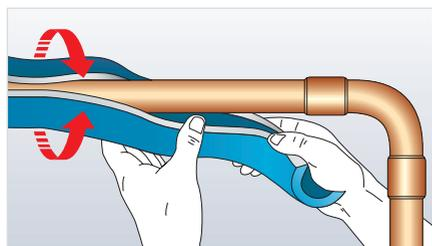
Abra la coquilla Armaflex preseccionada y colóquela sobre la tuberías (el papel de cubierta protege la tira autoadhesiva).
