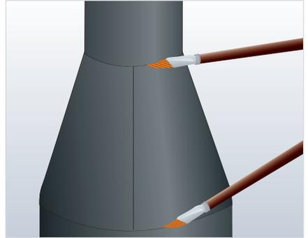
Aplique una fina capa de adhesivo a los bordes que se van a unir y deje que se seque. Presione los bordes, uniéndolos de forma firme en un extremo, luego en el otro y luego complete la unión.
