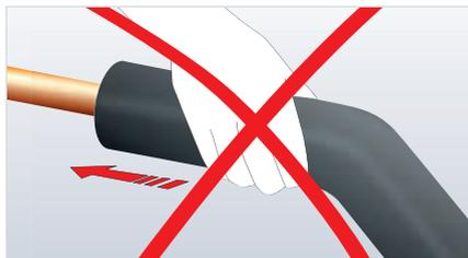
Siempre empuje la coquilla Armaflex sobre la tubería del modo indicado.
