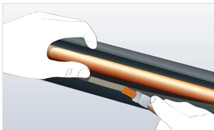
1. Seccione con un cuchillo afilado la parte plana de la coquilla a lo largo de toda su longitud.
