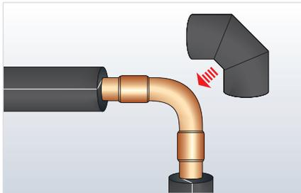
Aísle todas las demás secciones rectas de la coquilla siguiendo el procedimiento anteriormente descrito. Finalmente, aísle todos los codos, uniones en T, etc. (véase "Codo segmentado con una pieza central -2+1 empleando una coquilla Armaflex" en la página 23).
