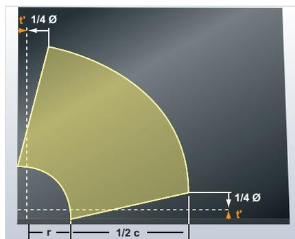
Divida la circunferencia de la tubería por la mitad y lleve sus dimensiones a la plancha Armaflex.
