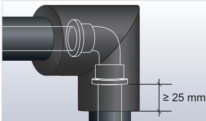
Aísle hasta la junta de la tubería empleando la coquilla Armaflex y fíjela a la tubería empleando adhesivo.
