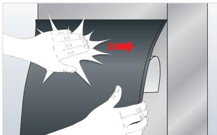
Retire el papel de protección entre 20 y 30 cm y alinee la plancha. Presione con firmeza para activar el adhesivo.
