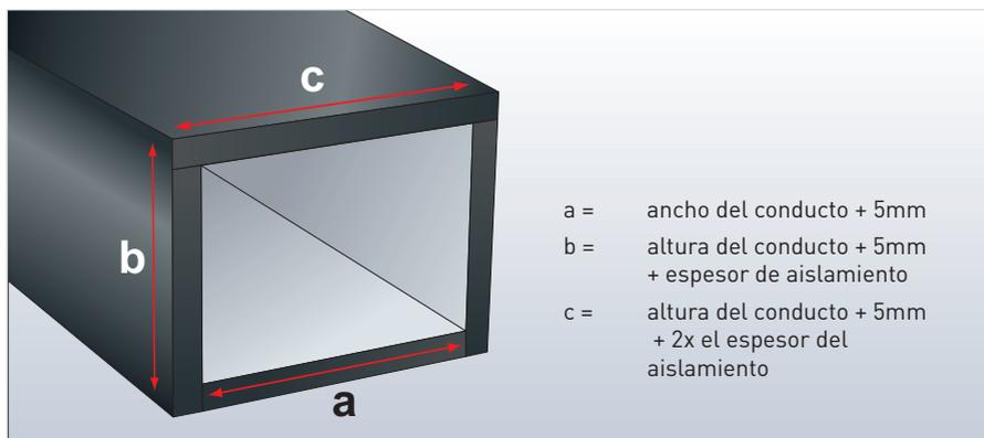
Limpie todas las superficies con el disolvente Armaflex para eliminar grasa, aceite, suciedad, etc. y corte las planchas a las medidas correctas.
