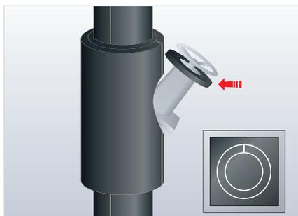
Corte la plancha y pégue el aislamiento al cuerpo del asiento de la válvula con adhesivo Armaflex.
