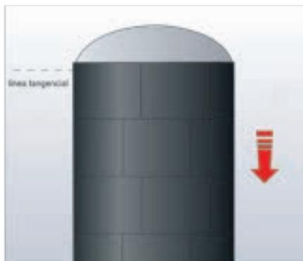
Instale los paneles de planchas Armaflex empezando en la sección del extremo curvo del recipiente de la forma indicada. Aplique adhesivo en ambas superficies.
