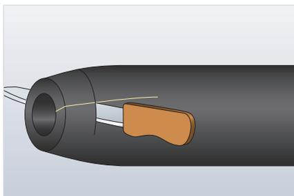
Corte el aislamiento para ajustarlo a la medida de la reducción. Haga un corte en el lado longitudinal.
