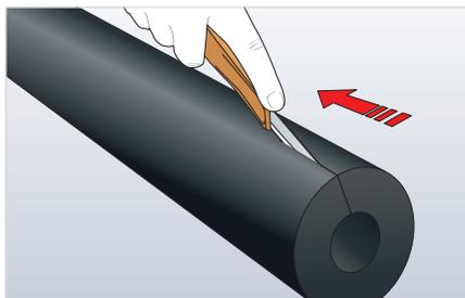
Emplee un cuchillo afilado. Mantenga el cuchillo en un ángulo agudo al seccionar la coquilla.
