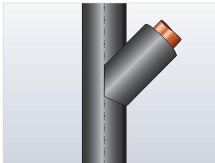
2. En la coquilla con el corte a  $45^\circ$ , marque un ángulo de  $22,5^\circ$  y realice un corte siguiendo esta línea, tal y como se muestra arriba.
