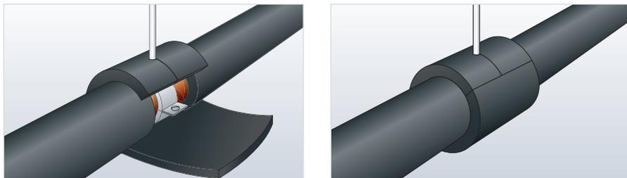
3. Coloque la cubierta de Armaflex sobre la zona del soporte, y marque y corte la circunferencia real de la cubierta. Fíjela y haga un sellado estanco de todas las costuras y uniones dentro y alrededor del aislamiento, empleando el adhesivo Armaflex.
