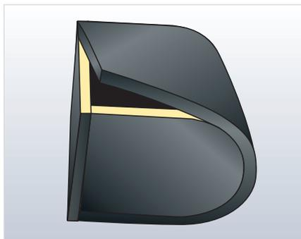
Enrolle suavemente los bordes del cuerpo del panel alrededor de los paneles terminales hasta que el panel de cubierta se parezca a una caja.
