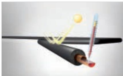
**HT/Armaflex** resistente a los rayos UV puede utilizarse para aplicaciones exteriores sin protección adicional contra los rayos UV.
