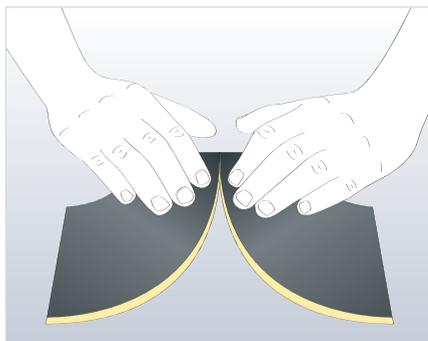
Coloque juntas las secciones por el dorso. Aplique el adhesivo Armaflex a los extremos exteriores.
