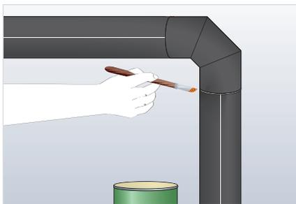
**Nota:** En principio la coquilla se puede simplemente deslizar a lo largo de los codos. Sin embargo, en el caso de codos pequeños en las tuberías (de radio pequeño) se presenta el riesgo de que el aislamiento se doble en el interior del codo, con lo que se reduce el espesor del aislamiento. En el sector de la refrigeración y el aire acondicionado, se impediría así alcanzar el espesor de aislamiento calculado y se puede producir condensación en la superficie
