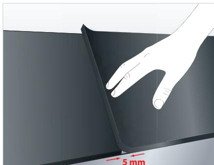
Las planchas cortadas se deben colocar de modo que se presente un solapamiento de 5-10 mm (para la compresión). No aplique adhesivo a esta zona ni en la plancha Armaflex ni en la superficie del conducto. Donde se unan dos planchas, deje una tira de 30 mm de plancha y de superficie del conducto sin adhesivo.
