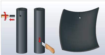
2. Coja un trozo grande de coquilla Armaflex, perforo un agujero pequeño para que pueda pasar el tornillo de la abrazadera; realice un corte con un cuchillo pequeño y afilado a lo largo de la cara plana de la coquilla.
