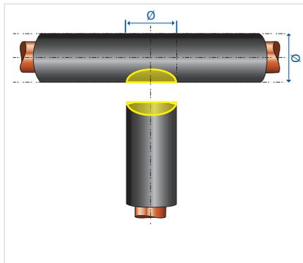
1. Realice un agujero en la coquilla principal con la ayuda de una sección de tubería afilada del diámetro adecuado, formando la cruz de la “T”.
