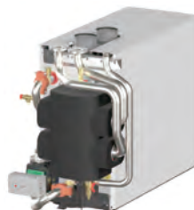
Kit botella de equilibrio Profundidad del kit 407 mm. Ida/retorno DN50. Conexión gas 1 1/2".
