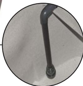
**Tubo de aspiración con válvula de pie y filtro incorporado**
