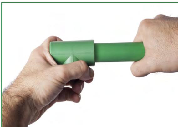
Finalizado el calentamiento, retirar tubería y accesorio de sus matrices e introducir uno dentro del otro hasta la marca formada por el arrastre de material de la tubería.
