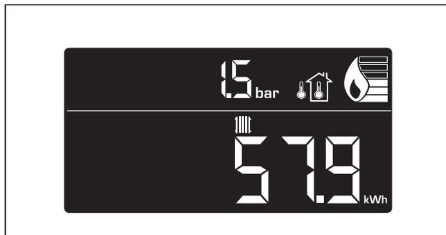
En la pantalla se ve la indicación inicial, con el estado de funcionamiento actual del producto. Al pulsar una tecla de selección, aparece en la pantalla la función activa.
