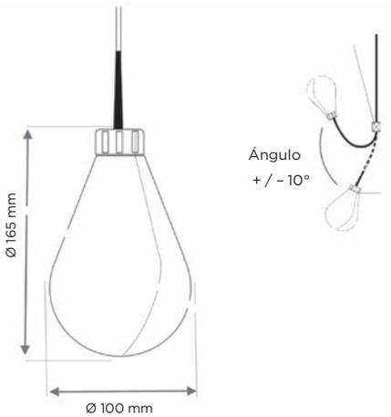
Se necesitan 3 flotadores si la estación tiene 1 bomba y 4 flotadores si la estación está equipada con 2 bombas.
