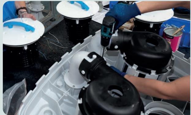
Una ingeniosa combinación de robots y humanos: las piezas son ensambladas a mano por operarios para trabajos meticulosos o por robots para las piezas más difíciles de transportar o montar.
