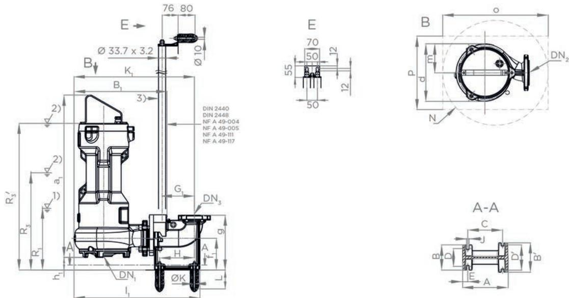
(1) Nivel mínimo de parada en funcionamiento automático (2) Sumergencia mínima en funcionamiento continuo (3) No suministrado por SFA
