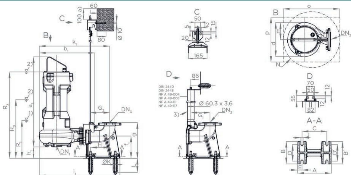
(1) Nivel mínimo de parada en funcionamiento automático (2) Sumergencia mínima en funcionamiento continuo (3) No suministrado por SFA
