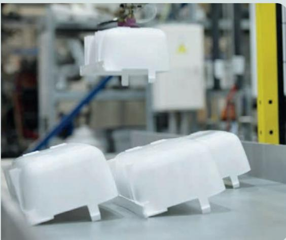
En la actualidad, la plasturgia en SFA son 33 máquinas y un total de 760 moldes. La línea está totalmente automatizada, del transporte de la materia prima de los silos hasta las máquinas y de las máquinas hasta la salida de los productos.
