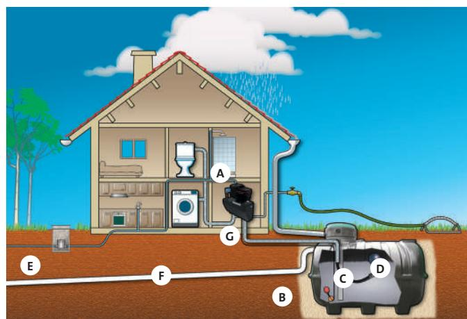
A: SISTEMA SCALA1 con B: Nivel flotante - C: Filtro flotante - E: Red de agua potable - D: Red de agua de lluvia - G: Agua de lluvia almacenada
