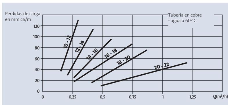
Para una tubería de recirculación formada por 20 m de tubería de RETORNO de  $\phi$  14 (14-16), y para una velocidad de caudal mín. de 0,5 m/s, el total de las pérdidas de carga para 0,3  $m^3/h$  estará en torno a:  $20 \times 40 = 800$  mm si  $HMT = 0,80$  mca.
