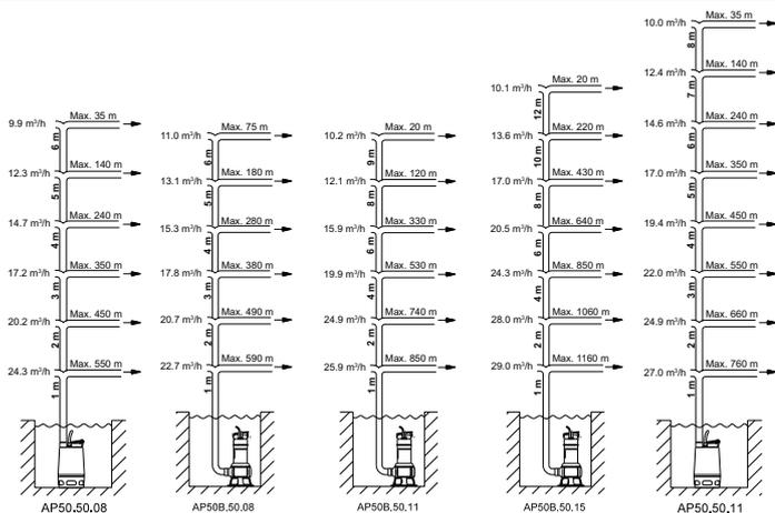
Usa la siguiente tabla para seleccionar la bomba Grundfos más adecuada para cada tipo de tarea con aguas residuales. Una vez determinado el modelo de bomba que necesita, utiliza la guía de dimensionamiento correspondiente para conocer el tamaño perfecto de la bomba.
