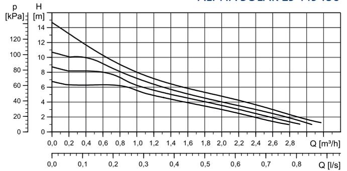
La circuladora funciona conforme a una curva constante, con potencia y velocidad constantes. El punto de funcionamiento de la circuladora varía a lo largo de dicha curva según las variaciones de la demanda de la instalación. La curva se selecciona con un solo botón.
