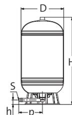
⚠ La presión de aire del depósito debe ajustarse en el momento de la instalación (aproximadamente 0,3 bar por debajo de la presión de arranque) y debe comprobarse como mínimo una vez al año, con el depósito vacío de agua (prevé la instalación de una válvula de aislamiento y otra de purga).
