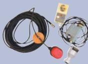
Caja de control con flotador de nivel, cable de 20 m, válvula de 2 vías y dispositivo antirretorno de agua potable. Gracias a su flotador colocado en la reserva a un nivel bajo, la caja controla el encendido / apagado de la bomba en caso de falta de agua y la apertura / cierre de la válvula. El ajuste del agua potable se realiza en la reserva y solo con la bomba en funcionamiento. En caso de corte de energía, la válvula magnética se cierra automáticamente.
