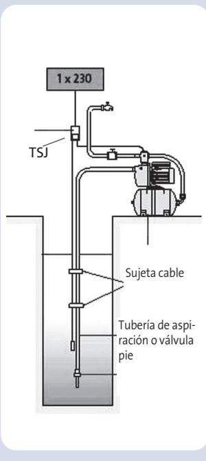
La bomba se para automáticamente cuando la sonda se encuentra fuera del agua. Cuando la sonda vuelve a estar en contacto con el agua y tras un intervalo de 150 seg, la bomba ya puede funcionar de nuevo. Ese intervalo evita que se produzcan arranques y paradas sucesivos, lo que podría perjudicar el funcionamiento de la bomba.
