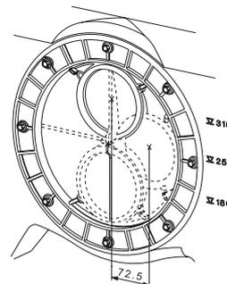
En las versiones MD y M, la entrada está ubicada en la parte trasera del tanque y está diseñada como un disco giratorio DN100 (DN150 opcional), que debe colocarse según se requiera entre 180 y 315 mm.
