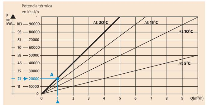
En nuestro ejemplo,  $P = 20.000 Kcal/h$  o  $23 Kw$ , se trata de una instalación de calefacción convencional con una  $\Delta t = 20^\circ C$  donde obtenemos un caudal de  $1 m^3/h$
