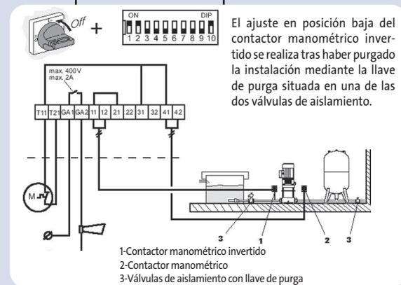
El uso de un contactor manométrico invertido adicional tipo MXM 06 en la tubería de aspiración permite garantizar la protección contra la falta de agua. La bomba se detendrá en caso de caída de la presión medida en la tubería de aspiración; este principio de funcionamiento sólo es válido en una instalación en la que el agua extraída se encuentre por encima o al nivel de la bomba. La reactivación de la bomba tendrá lugar automáticamente una vez restablecida la presión aguas abajo.
