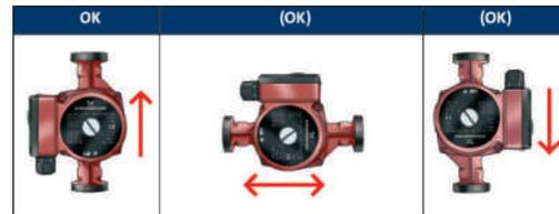
La bomba debe instalarse sobre la tubería de RETORNO, en las posiciones más alejadas.
