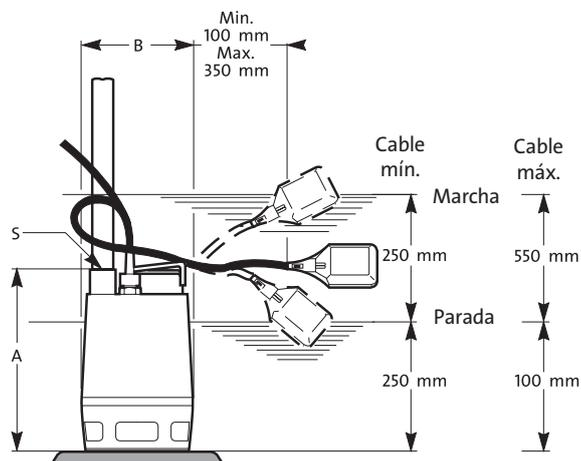
Profundidad de la instalación: máx. 10 m por debajo del nivel del agua.
