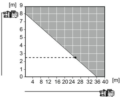
Ejemplo: si la altura de aspiración es de 2,5 m, la longitud horizontal de la tubería no deberá exceder los 25 m.
