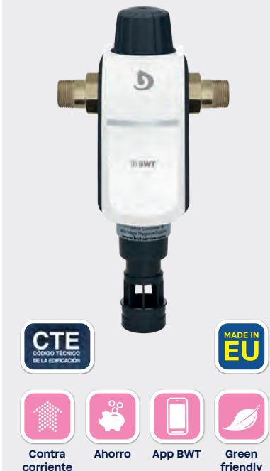
» **La gama de filtros BWT R1 CTE siguen las especificaciones marcadas en el Código Técnico de Edificación, sección HS4:** filtro con un umbral de filtrado comprendido entre 25 y 50 µm, con malla de acero inoxidable y baño de plata, para evitar la formación de bacterias, y autolimpiante.
