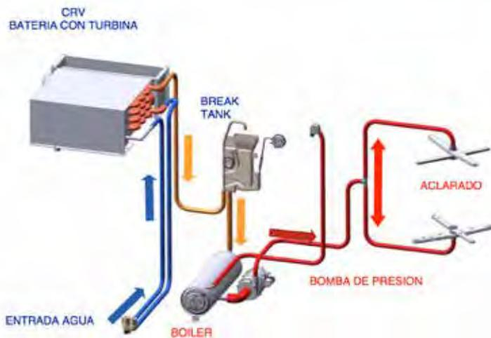
**Condensador de vapores y recuperación de calor CRV y Sistema HY-NRG**
