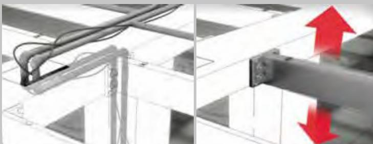
La estructura de soporte se ha diseñado para que quepa la instalación (tubos de gas, cables electricos, etc.) que de este modo resultan invisibles. Los barrotes de apoyo disponen de un sistema de regulación milimétrica que garantizan un montaje perfecto
