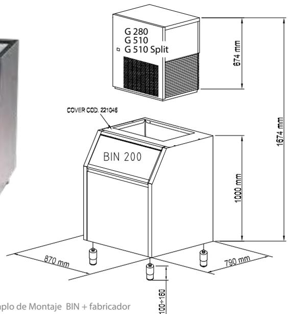
Ejemplo de Montaje BIN + fabricante
