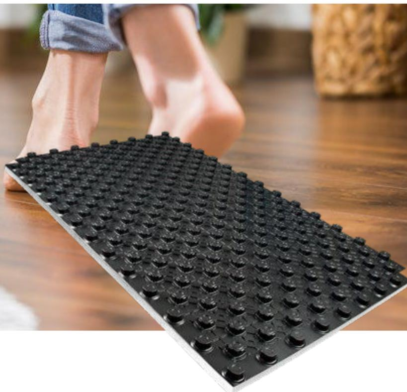
La gama de placas de nopas Stark, "fuerte" en alemán, incluye varios modelos fabricados en EPS con **acabado termoconformado rígido**. Combina tuberías de polietileno resistente a la temperatura PERT de Ø16mm y placas aislantes machihembradas a 4 caras que permiten cumplir con prácticamente todos los requerimientos de altura y nivel de aislamiento térmico y acústico.
