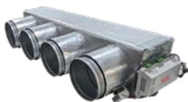
Kit plenum Rothaclima. Disponible hasta 7 salidas de 150 o 200 mm. Listo para instalar en el equipo de aire, totalmente aislado, con compuertas motorizadas cableadas de fábrica a Central Rothaclima.
