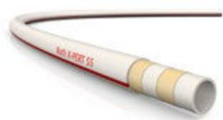
**X-PERT S5** Tubo de 5 capas fabricado en PERT tipo II (polietileno resistente a la temperatura) mediante co-extrusión para obtener una tubería de máxima flexibilidad. Incorpora barrera antioxígeno EVOH en la capa intermedia. Disponible en Ø11, Ø16 y Ø20 mm. Certificado por Aenor bajo la norma UNE-EN ISO 22391.
