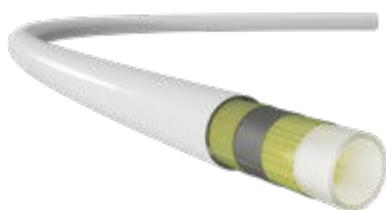
Exclusivo para instalaciones de suelo radiante frío/calor. Compuesto por una capa interior de PERT, una capa central de aluminio soldado a tope y una capa externa de PERT. El aluminio actúa como barrera antioxígeno, mejora la resistencia y la ductilidad, haciendo que el tubo mantenga
