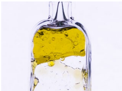
Funcionamiento Rothagras El funcionamiento del equipo se basa en la diferencia de densidades entre el agua y el aceite. Dentro del Rothagras los sólidos decantan mientras que los aceites flotan quedando como sobrenadante. De esta forma, el agua sale pretratada y libre de estos contaminantes.
