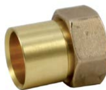
Racor 3/4" hembra esferocónico x 22 mm a soldar
