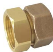
Racor 3/4" hembra esferocónico x 3/4" hembra asiento plano
