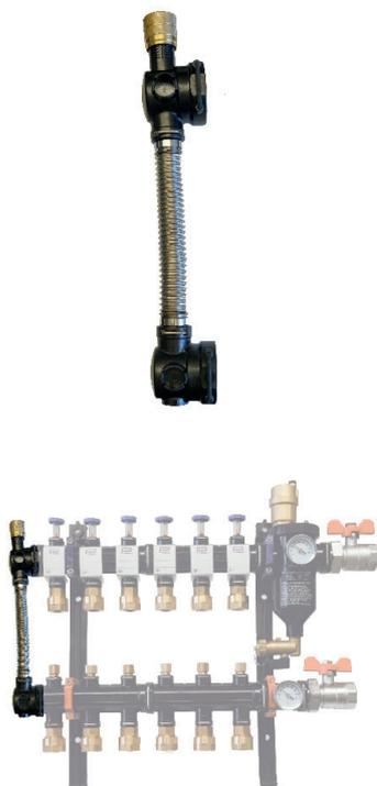
Válvula de presión diferencial para montaje en distribuidor. Permite mantener un caudal suficiente a las bombas de circulación y aerotermia cuando cierran los circuitos. Su montaje se realiza extrayendo los tapones del distribuidor y colocando esta en su lugar mediante las horquillas de inox.
