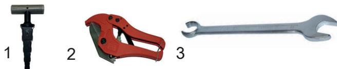
1.- Calibra el diámetro interior del tubo y rebarbar la arista para que al montar el accesorio no dañe la junta.
