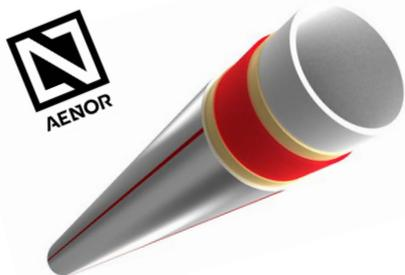
Tubo **POLYTHERM EVOHFLEX PRO** Antidifusión Ø16x1,8 Y Ø20x1,9 Pert-II. Certificado según norma UNE EN ISO 22.391. Con recubrimiento exterior de polímero con micro partículas metálicas para evitar que la humedad entre en contacto con la capa de evoh lo que:
