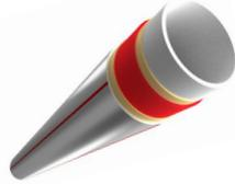
Tubo **POLYTHERM EVOHFLEX PRO** Antidifusión  $\varnothing 12 \times 1,4$  Pert-II. Certificado según norma UNE EN ISO 22.391. Con recubrimiento exterior de polímero con micro partículas metálicas para evitar que la humedad entre en contacto con la capa de evoh lo que:
