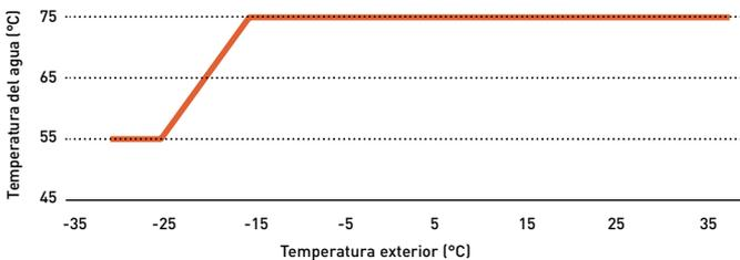
\* Para la serie M. En caso de funcionamiento de la serie L hasta -25 °C y salida del agua de 75 °C hasta -10 °C ambiente.
