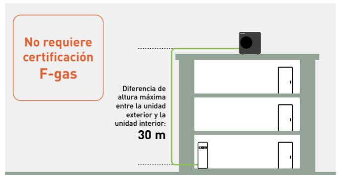
\* Para la serie L sólo cuando la unidad exterior está instalada por encima de la unidad interior, y la presión del agua no supera 1 bar en la unidad exterior.
