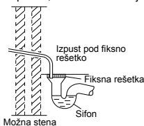
Risba napeljave odvodne cevi na prsto
