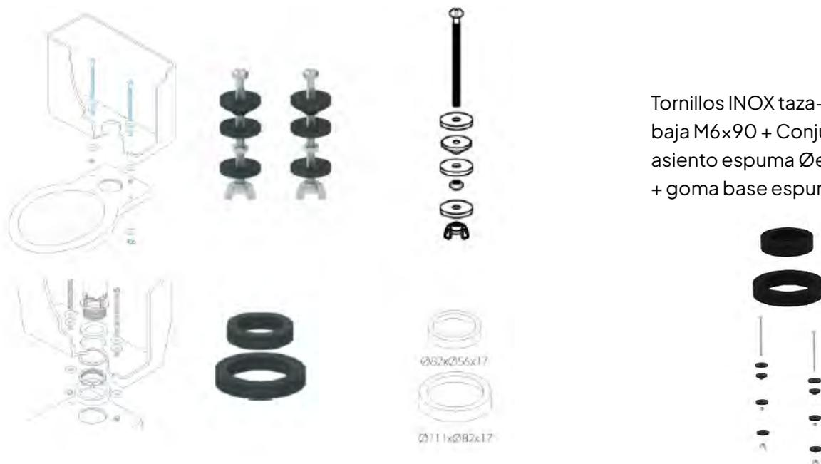
Tornillos INOX taza-cisterna baja M6x90 + Conjunto goma asiento espuma Øext 111 mm T.B + goma base espuma T.B
