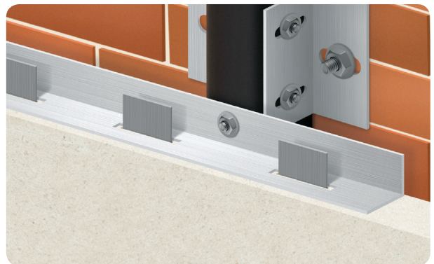
Fijación mediante perfiles a la baldosa ranurada
