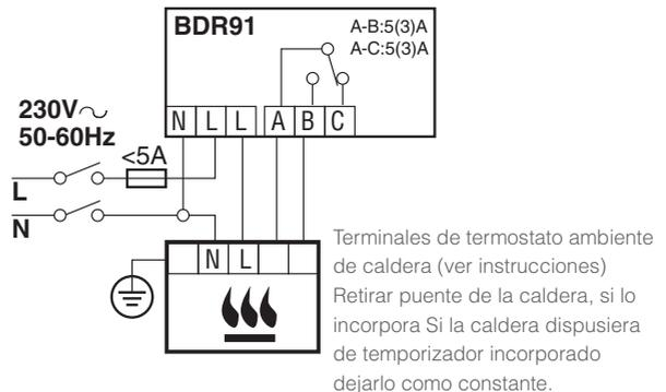
**Figura 5** Conexión de una válvula de zona de dos vías
