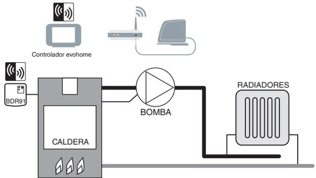
**Figura 2** Agua caliente acumulada y sistema de calefacción zonificado. El sistema necesita HR92 u otras soluciones de zonificación para los radiadores.
