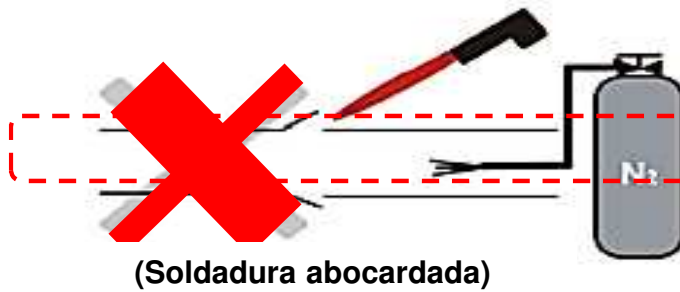
soldadura en tubo ensanchado
